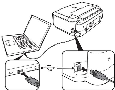
使用 USB 电缆线将打印机连接至计算机。
