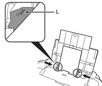
滑动左右纸张导片，使其紧靠纸张两侧边缘。
