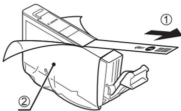
按照箭头所示方向拉橙色胶带 (1) 以撕下保护薄膜并完全地取下薄膜 (2)。
