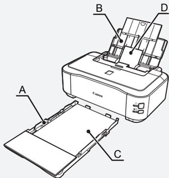
纸盒仅支持普通纸 (C)。要打印照片纸 / 明信片纸 (D)，确保将其装入后端托盘。
