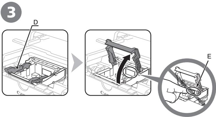
稳固地抬起打印头支架的打印头锁定杆 (D) 直到其停止。
