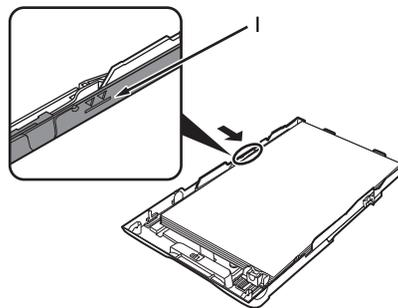
滑动纸张导片使其紧靠纸张左侧边缘。
